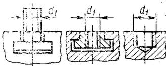
**Диаметр центрального базового отверстия**
