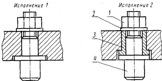
1 — гайка по ГОСТ 5927; 2 — шайба по ГОСТ 11371; 3 — втулка с буртиком по ГОСТ 12214; 4 — установочный сменный палец цилиндрический или срезанный
