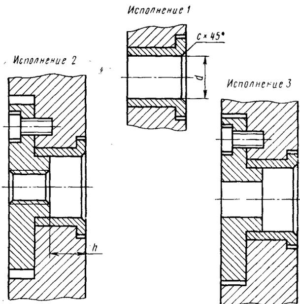
Исполнения: 1 — центральное отверстие свободно для прохода заготовки; 2 — с базированием на центральное отверстие установлена втулка с резьбовым отверстием для крепления заготовок; 3 — с базированием на центральное отверстие установлена втулка с направлением для штока гидро- или пневмопривода.
