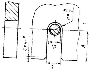
1.12. В конструкциях приспособлений, имеющих механизмы для фиксации подвижных частей, необходимо предусматривать стопорное устройство, обеспечивающее жесткость фиксации частей приспособления.
